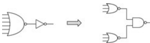
图 5-3 变换电路结构可以减少门的扇入
