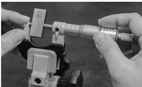
图 2-20 0~25mm 外径千分尺校准
