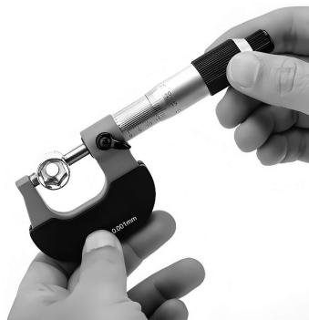
图 2-21 螺母套筒的直径测量
