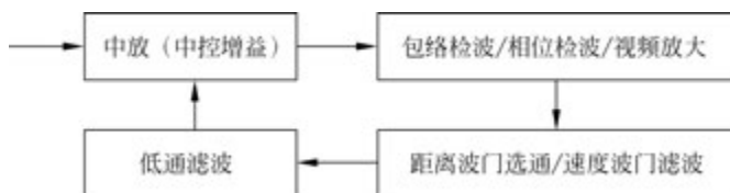
图 3-29 AGC 电路的工作原理
