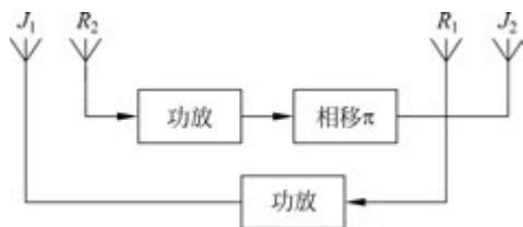
图 3-26 收发互补型天线(反向天线结构)
