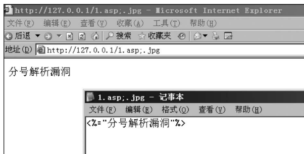
图 3-5 包含 ASP 代码的“1.asp;.jpg”会被 IIS 解析为 ASP 文件
