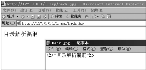
图 3-4 包含 ASP 代码的 hack.jpg 被 IIS 解析为 ASP 文件
