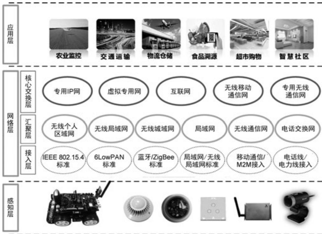
图 5-11 物联网层次结构模型
