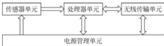
图 5-31 传感器节点的单元模块构成
