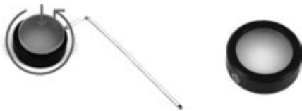
图 3-7 毛玻璃安装示意
