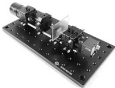
图 3-6 同轴光谱色散套件系统实物
