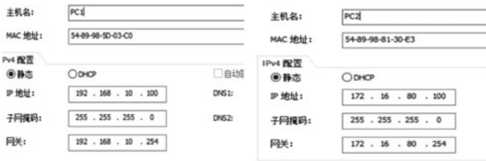
图 5-18 配置 PC1、PC2 主机的 IP 地址
