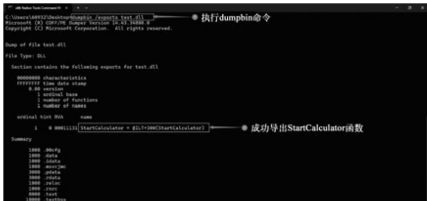
图 3-7 使用 Dumpbin 工具验证 test.dll 成功导出 StartCalculator 函数
