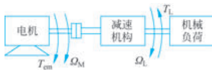
图 3.8 电力拖动系统做旋转运动时的结构示意图
