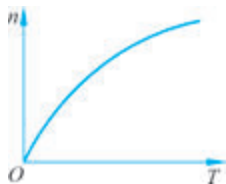
图 3.12 通风机类负载的转矩特性
